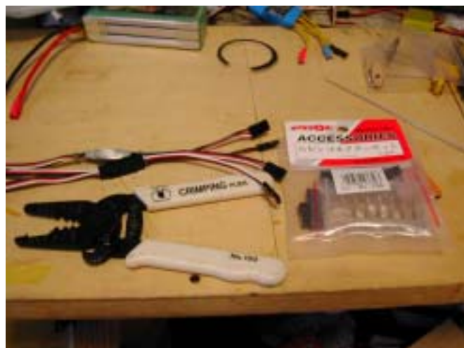
延長ケーブルと6ピンコネクターを使いハーネスを製作します。
