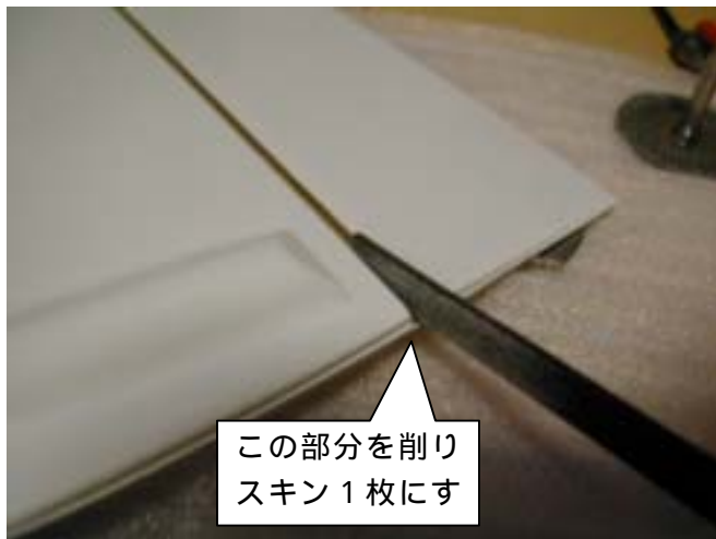
ヤスリで写真の部分を削りラダーが可動する ように加工する。
