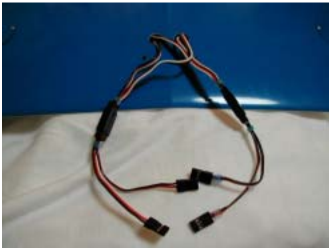
6ピンコネクタによりフライト時の組み立てが簡単になるうえに誤接続が皆無になります。
