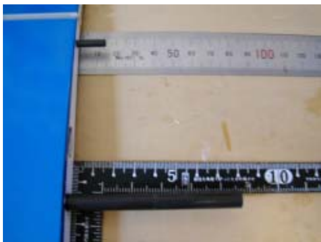
外翼側に短いパイプを15mm長いパイプを60mm挿入しエポキシ接着剤で固定します。周囲に着いたエポキシ接着剤は，アルコールで綺麗に拭き取っておきます。
