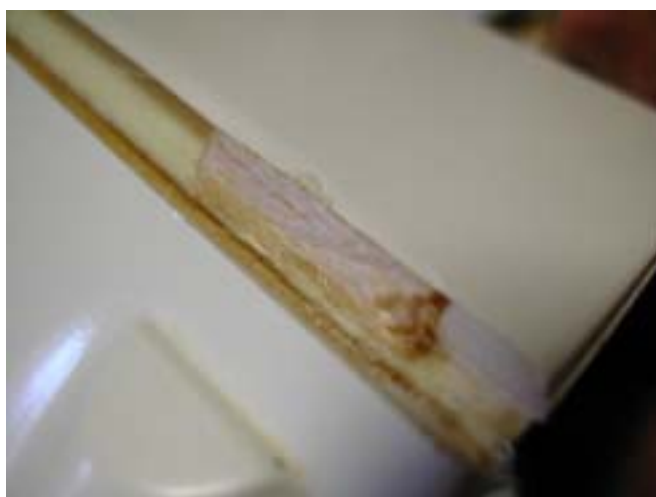
エルロンと同様に補強材を取り付けます。
